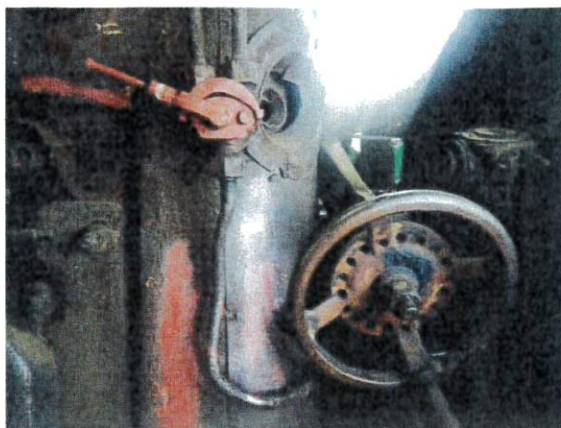
Stanowisko maszynisty. Koło nawrotnicy, część kranu hamulca zespolonego i zawór piasecznicy
