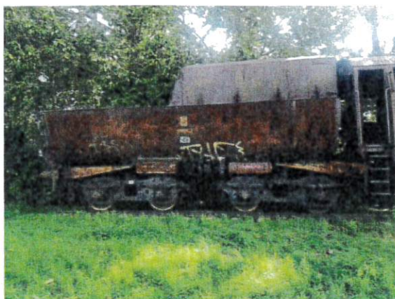
Tender 30D43 prawa strona, malatura zupełnie zniszczona
