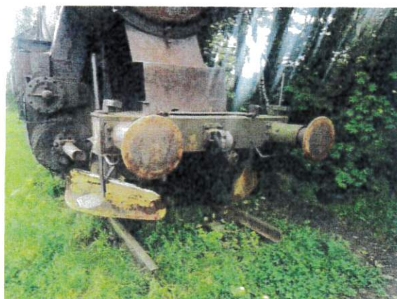
Czołownica parowozu, brak reflektorów i końcowych przewodów hamulcowych
