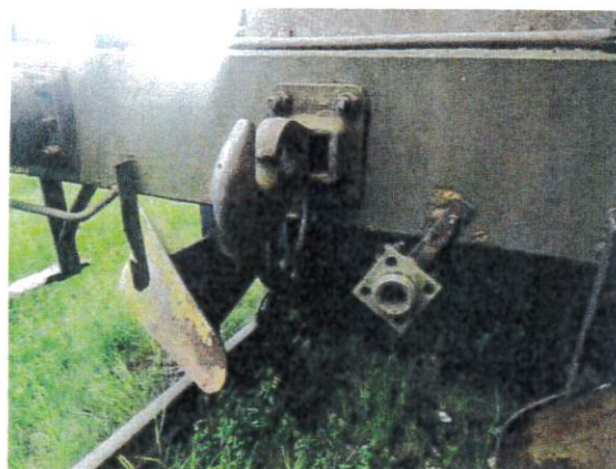
Niekompletny sprzęg śrubowy, brak zaworu sprzęgu grzewczego
