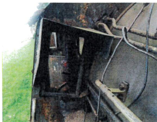
Przednie okno maszynisty, brak szyb, rama zamontowana
