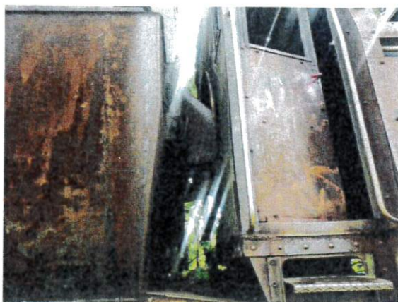
Przód tendra i tył budki maszynisty, brak brezentowej opończy
