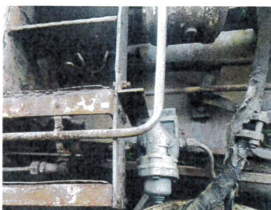
Zawór rozrządczy hamulca oraz u góry pomocniczy zbiornik powietrzny 14 litrów
