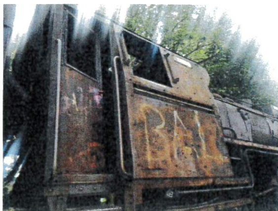
Budka maszynisty z zewnątrz, brak wszystkich okien
