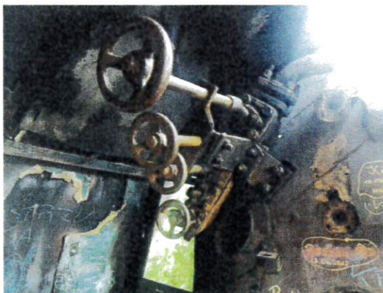
Odbiornica pary. Widoczny brak lewego wodowskazu.
