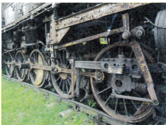
Ty2-14 Zdekompletowany układ napędowy z prawej strony
