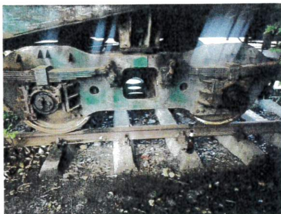
Lewa strona, przedni wózek, brak pokryw i dolnej części łóżyska na przedniej osi
