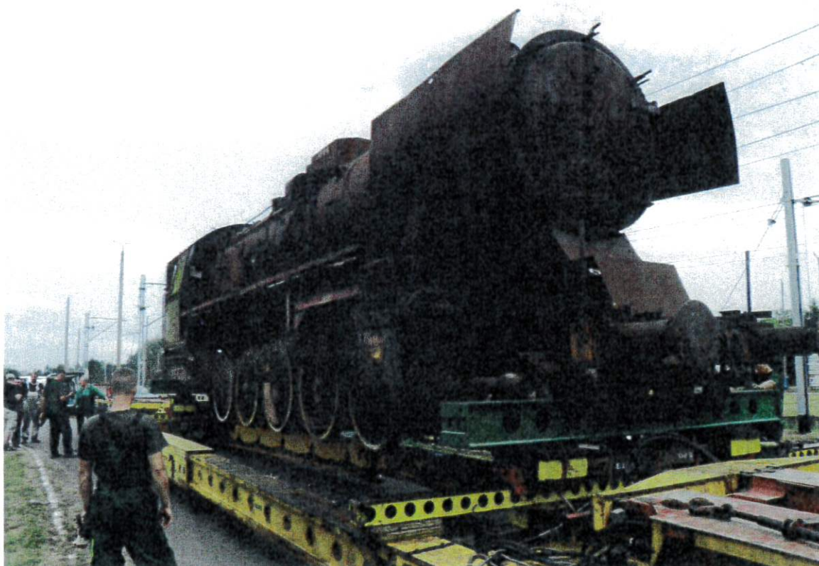
Załadunek na specjalną przyczepę parowozu metodą siłowników
