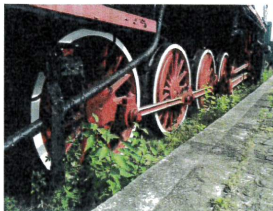
Ty42-120 Kompletny układ napędowy z prawej strony widoczny od tyłu
