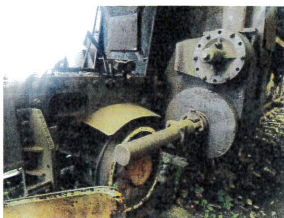
Lewy silnik parowy. Zamontowane pokrywy cylindra suwaka oraz osłony trzona tłokowego
