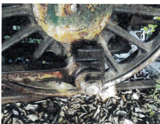
Wiązar na czopie koła V osi dowiązanej, brak nakrętki na smarownicy
