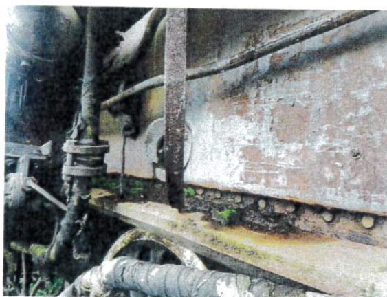
Skorodowane blachy boczne stojaka i klap popielnika
