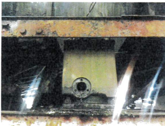
Prasa smarna Boscha, brak dźwigni napędu
