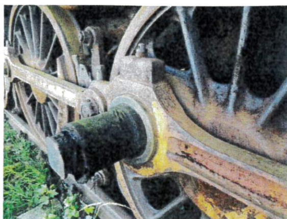
Czop zestawu napędowego owinięty szmatą
