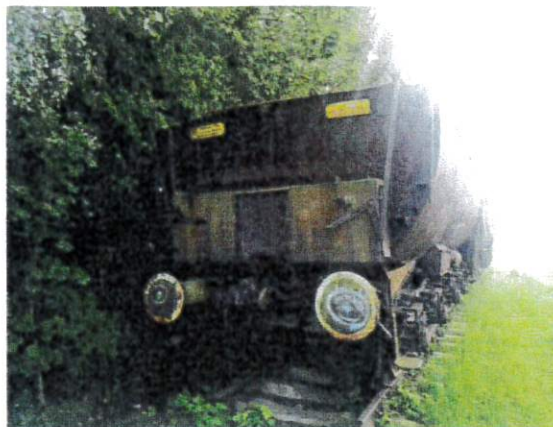
Tender 30D43 z tyłu, brak reflektorów i sprzęgów
