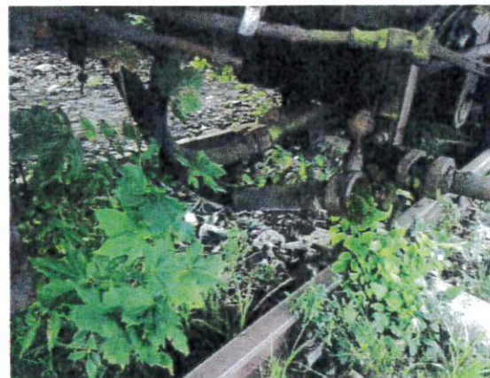
Resztki przewodów wodnych i powietrznych pomiędzy parowozem a tendrem
