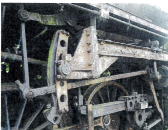
Główne elementy układu stawidła, kulisa, wodzikło, wał stawidłowy.
