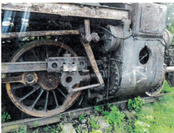
Prawy silnik widziany od tyłu. Wszystkie zasadnicze elementy zamontowane
